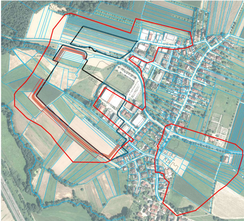
Abbildung 3: Bereich, der gegenüber HWGK durch Drohnenbefliegung und terrestrische Vermessung aktualisiert wurde
