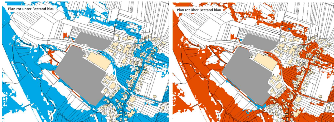
Abbildung 7: Berechnete Ausdehnung der Überschwemmungsgebiete (blau = Bestand, rot = Plan)
